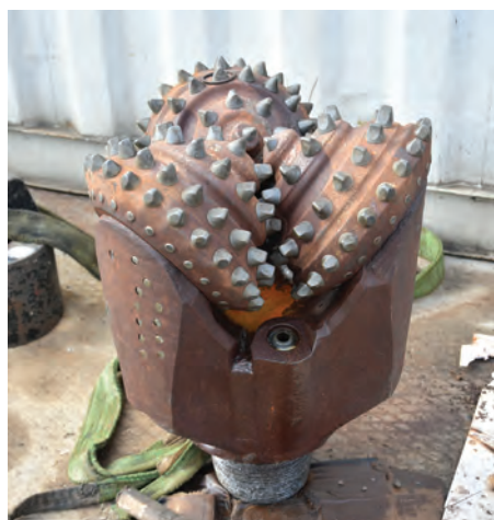
// Świder używany do przewiercania skał podczas odwiertu.
