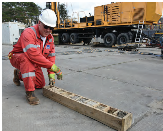
// Próbkę ziemi wydobytej z różnej głębokości podczas odwiertu.
